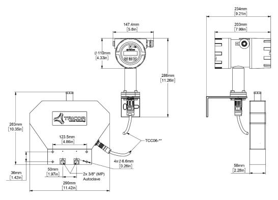
Fig. 33: Meter Dimensions TCMH 0450, Ex3
