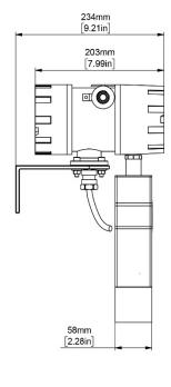
Fig. 32: Meter Dimensions TCMH 0450, Ex/Ex1
